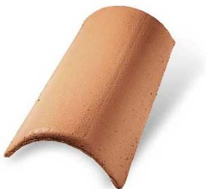
È un elemento a forma curva che viene posato lungo la linea d'incontro tra due falde, sia sulla linea orizzontale sia sulla linea di displuvio, con un sormonto minimo di 7 cm, per garantire la tenuta all'acqua. La tegola di colmo è compatibile e disponibile per tutti i profili e in tutti i colori del manto di copertura posato.
